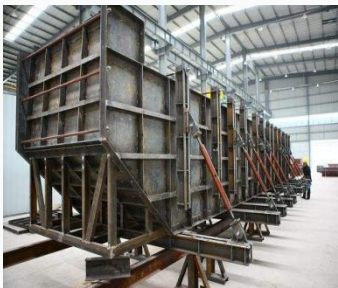
高架桥盖梁模板
