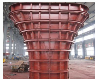
高速公路墩柱模板
