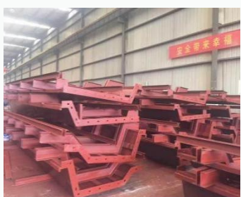
高架桥系梁模板
