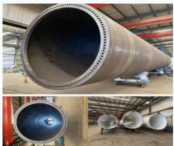
地铁墩柱模板
