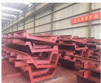
高架桥系梁模板
